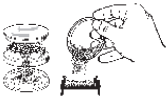
Befüllen der Füllkammer bis maximal zum unteren Trichterrand
