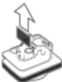
Das Sieb aus der Kühleinheit ziehen.
