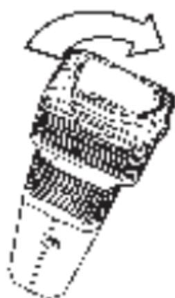
Kühleinheit durch eine 90° Drehung im Uhrzeigersinn auf den Verdampfer anschrauben.
