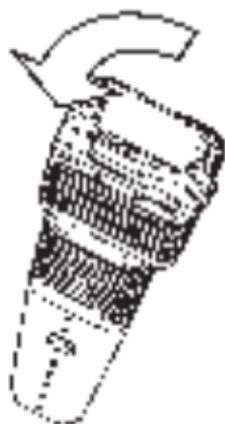
Kühleinheit durch eine 90° Drehung entgegen dem Uhrzeigersinn vom Verdampfer abschrauben.
