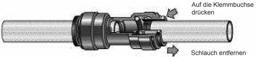
Schieben Sie den Schlauch soweit fest in die Muffenverbindung bis der Schlauch sich nicht mehr bewegt. Versuchen Sie den Schlauch herauszuziehen, um sich zu versichern, dass die Verbindung hält. Falls sich der Schlauch herausziehen lässt, schieben Sie ihn nochmals soweit wie möglich hinein.
